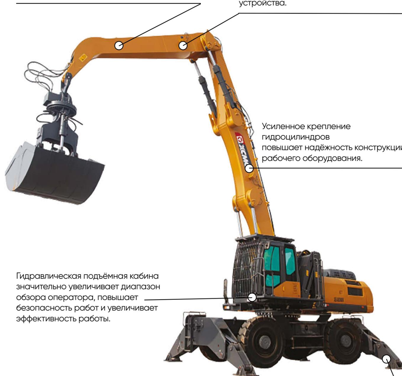
Безопасность значительно повышается, эффективно предотвращается столкновение и опрокидывание. Установлено уникальное сенсорное оборудование угла рабочего устройства. С помощью различных приспособлений можно настраивать диапазон перемещения рабочего устройства.
