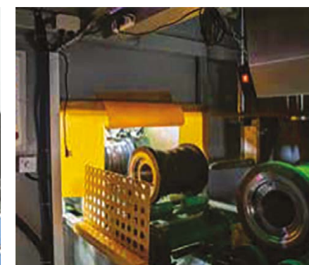
Магнитопорошковый дефектоскоп для обнаружения поверхностных трещин материала
