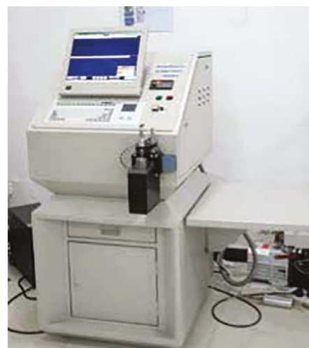
Спектрометр прямого считывания для анализа химического состава материалов
