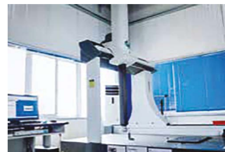
Трехкоординатный измерительный комплекс для точного определения формы и размеров изделия в трехмерном пространстве
