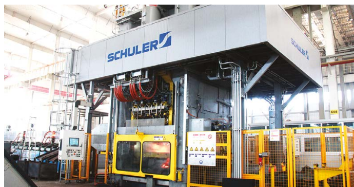
Ковочная линия Schuler из пяти участков, линия закалки и отпуска избыточным теплом
