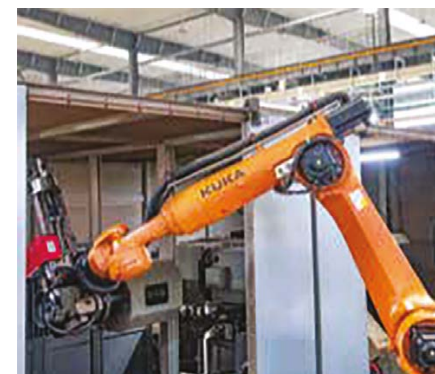
Автоматическая линия сварки опорных катков из двух станций
