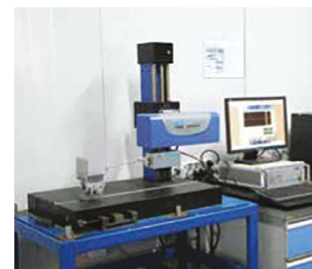
Измеритель шероховатости для точного определения профиля поверхности изделия
