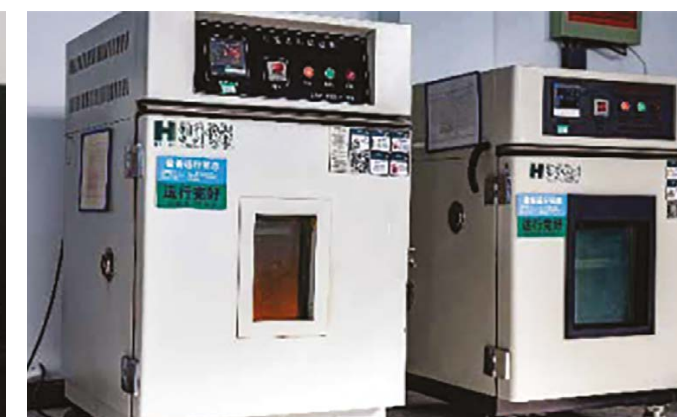
Камера обжига уплотнительных элементов для проверки скорости остаточной деформации резиновых деталей при высокотемпературном сжатии
