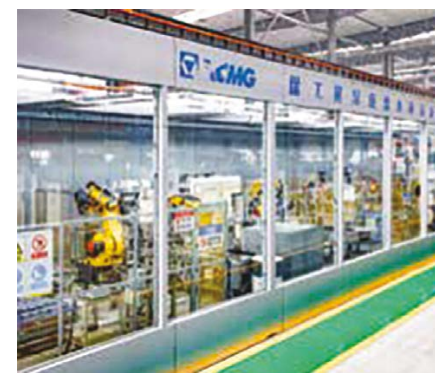
Автоматизированная линия сборки опорных катков без образования пыли
