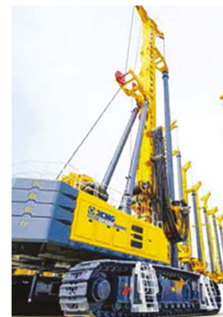
Гусеничное шасси крупнейшей в мире роторной буровой установки грузоподъемностью 520 т
